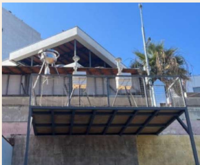
Estación de monitoreo meteorológico y calidad de aire instalada en el Centro Educativo CEIA.
