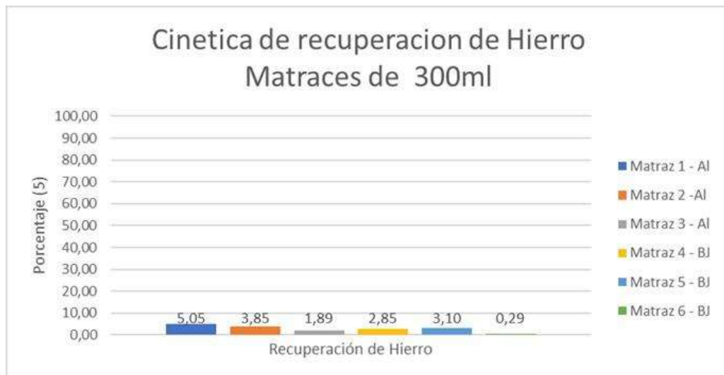
Figura 2. Recuperación de hierro en la prueba de biolixiviación en matraces
