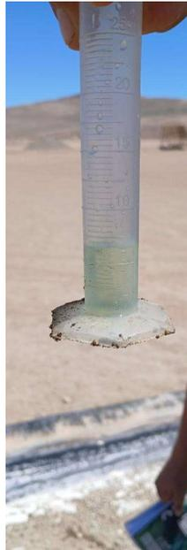
**Figura 1. Determinación del flujo en la irrigación de la pila de lixiviación**
