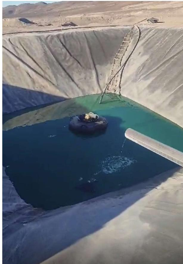
Figura 1. Piscina de solución de PLS para etapa de puesta en marcha de proceso de cementación en faena ubicada en camino Caleta El Cobre.
