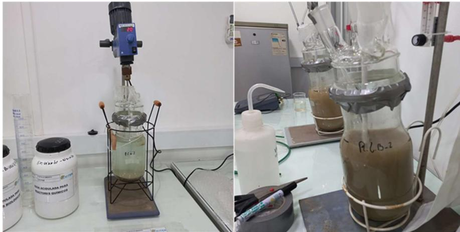
Figura 1. La prueba se desarrolló en reactores de vidrio de 2 L, con agitación constante con volumen constante y ISO pH
